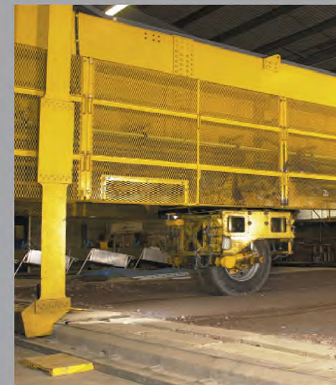
2000 – 英国交通实验室进行的足尺试验将坦萨格栅与大量其它格栅进行比较。
