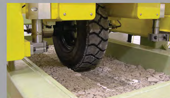
2007 坦萨技术中心 – 室内行车设备可以对格栅、填料和路基进行研究。
